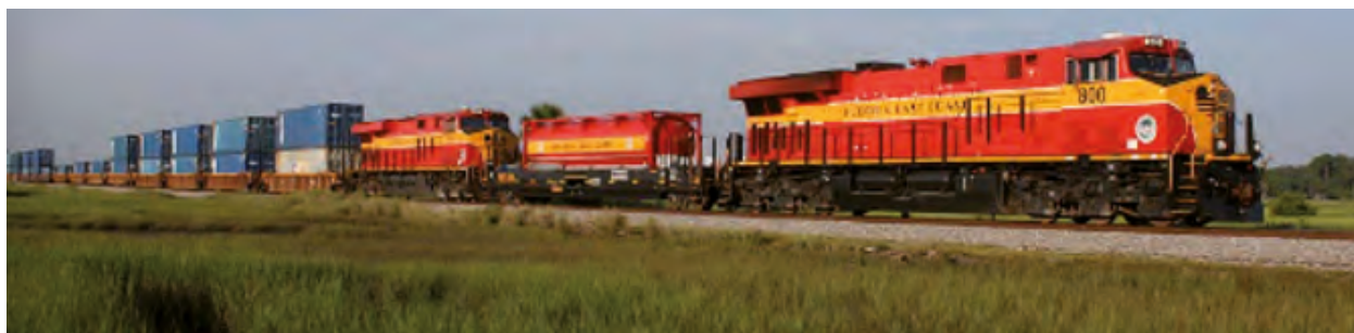
Fotografía 3: Desarrollo de pruebas en vía locomotoras duales GNL del Florida East Coast Railroad (Fuente: Chart Industries- 2017)
