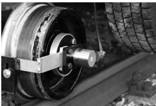
Fig. 5 Ruedas adicionales para desplazarse por las vías
