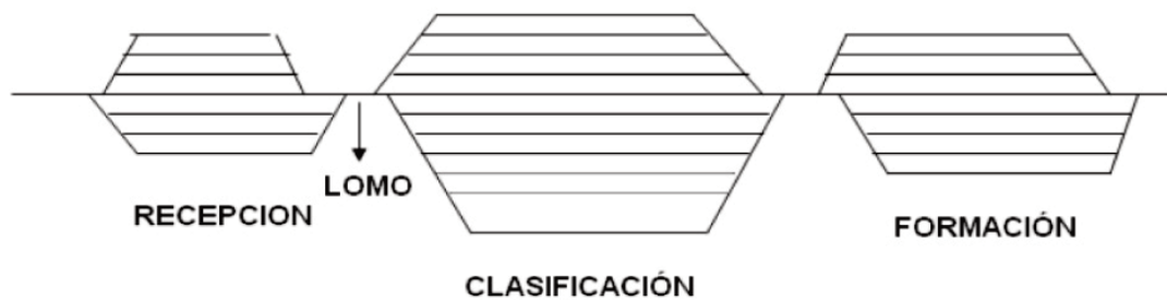
Figura 1. Esquema de estación de clasificación de mercancías.
