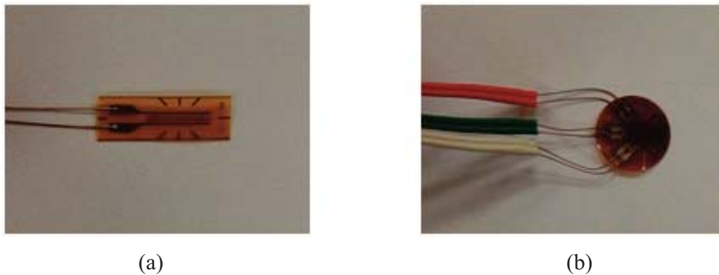
Fig. 7. Tipos de galgas extensométricas según medida de deformaciones: (a) Una sola dirección; (b) Tres direcciones.
