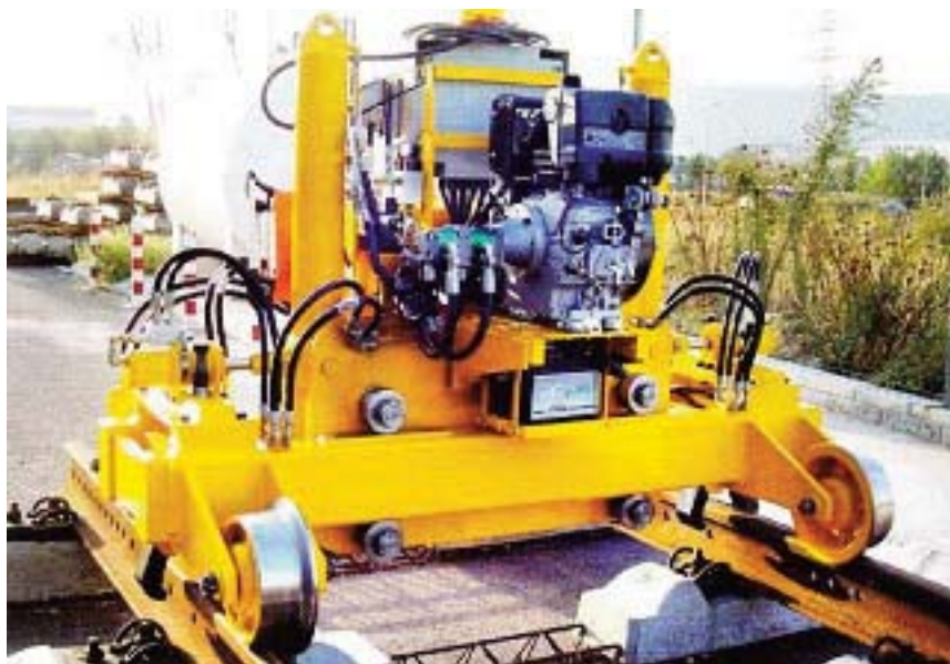
Fig. 4 Maquina centradora de vías
