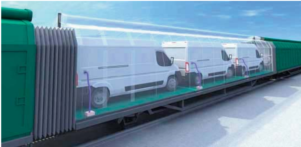
Figura 4: Vagón gusano cargado con tres furgonetas posicionadas para recargar sus baterías durante el viaje.
