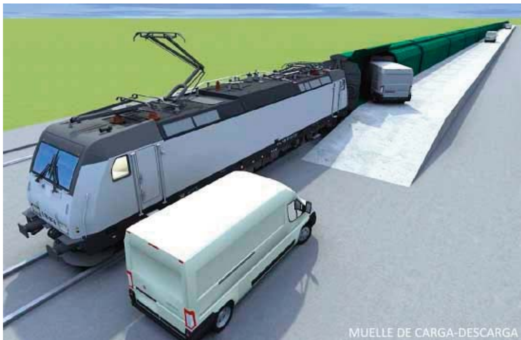
Figura 6: Carga de un tren VANELECTRA en una terminal adaptada a tal efecto.
