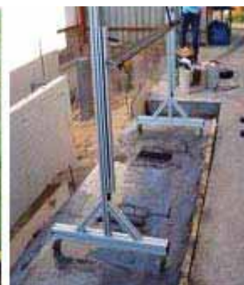
Figuras 8 ,9 y 10: Vista general de la disposición del prototipo en el ensayo de carga vertical estática.; Vista general del prototipo en el ensayo de carga estática angular (22°); Disposición del ensayo de aislamiento eléctrico.
