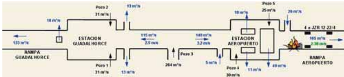
Figura 10. Esquema de resultados de simulación con ventiladores de chorro en Rampa Aeropuerto
