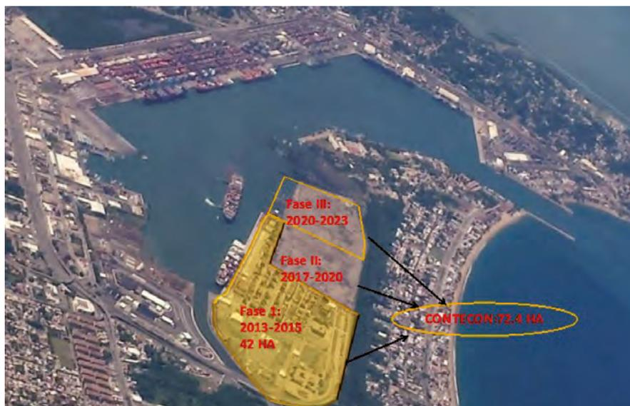
Se encarga del manejo de carga contenerizada. Cuenta con dos muelles de posición de atraque, en específico el número 18 y 19, que tienen una longitud de 360 metros por 35.48 metros de ancho. Entre los tipos de maniobras que realiza CONTECON son:
