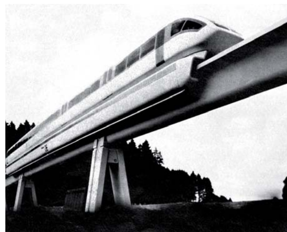
Fig. 2. Vehículo con guiado magnético, en ensayo en la República Federal Alemana. (Cortesía de A.I.T.).
