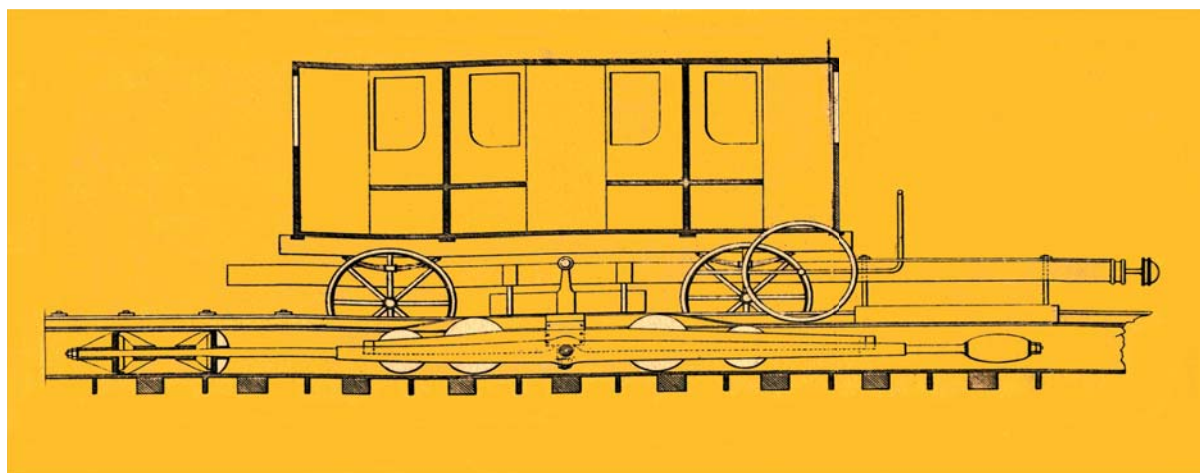
Fig. 258. Vehículo-motor del sistema atmosférico y sección transversal del tubo y del pistón. Revista Annales des Ponts et Chaussées (1844). (Escuela de Ingenieros de Caminos).
