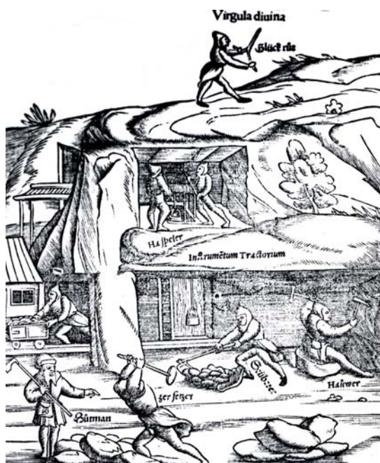
Fig. 44. Vagoneta minera y vía con guiado por el carril, según Muenster (1550). (Biblioteca Nacional).
