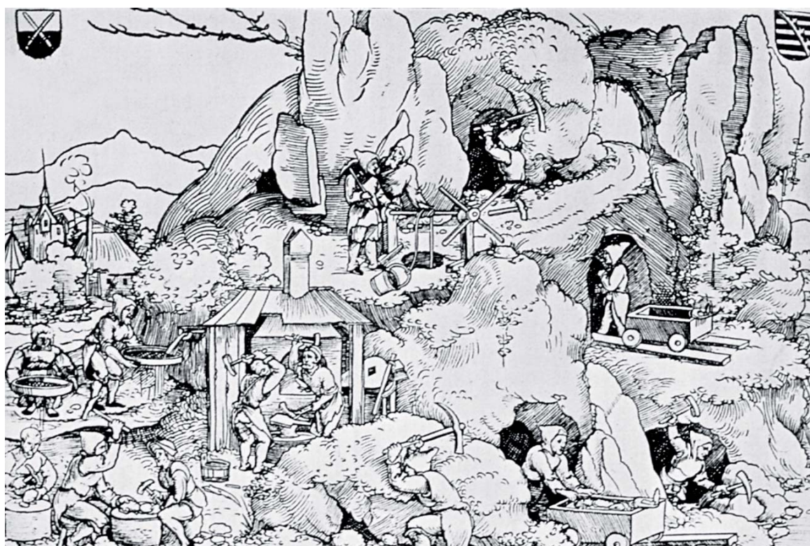
Fig. 41. Vagoneta minera utilizada en Sajonia, según Das Sachische Bergwerk (hacia 1525). (Bergbauforschungs Gmbh. Bibliothek, Essen).
