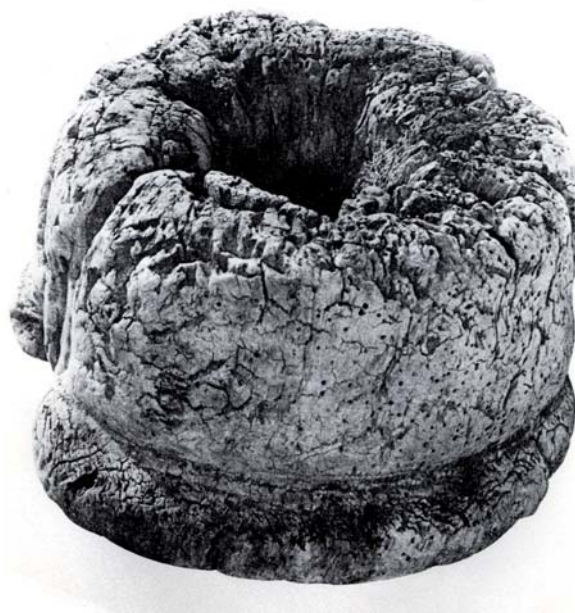
Fig. 67. Rueda de madera con pestaña, descubierta en una mina de carbón de la Broseley (Inglaterra). (Archivo RENFE).
