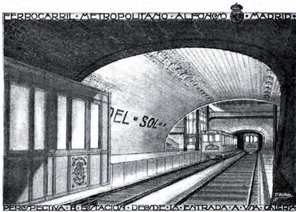
*Fig. 62: Boceto de una estación del Metropolitano madrileño. La estructura de la estación, con una separación entre la zona de andenes y un espacio más amplio para las escaleras y ascensores de acceso recuerda a las estaciones parisinas que podemos observar en el primer anexo. Fuente: Madrid Científico nº 907.*
