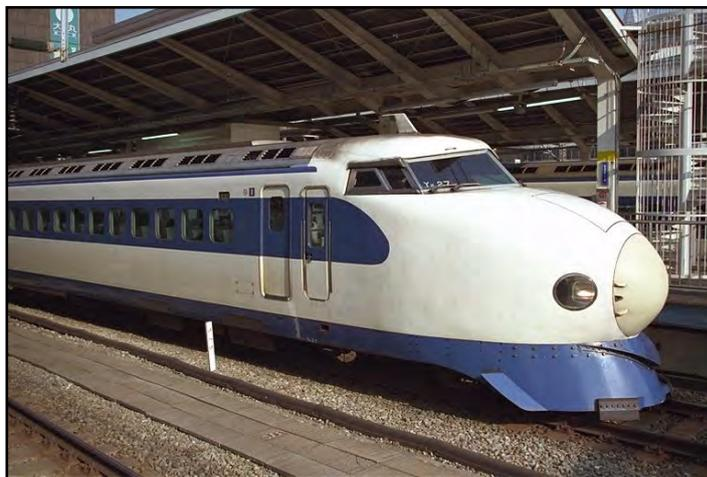
*Figura 2.1.- Rama de alta velocidad de la Serie 0. Esta serie se puso en servicio por primera vez en 1964 en el “Tokaido Shinkansen”. Fuente: JRW.*
