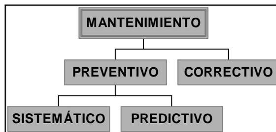
Figura A-VIII.1.- Esquema de los tipos de mantenimiento. Fuente: INEM (1992).
