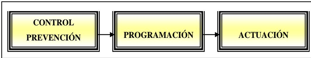
Figura A-VIII.5.- Esquema simplificado del mantenimiento según estado. Fuente: García Díaz de Villegas (2000).
