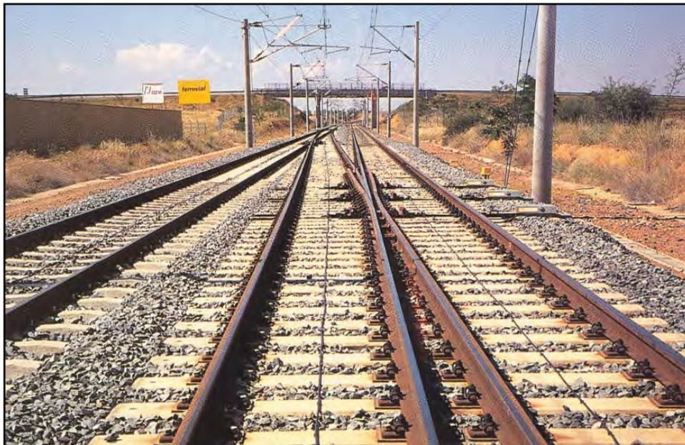
*Figura 4.18.- Escape en la línea del AVE Madrid – Sevilla; se puede apreciar el corazón móvil de uno de los desvíos. Fuente: RENFE – AVE (1992).*
