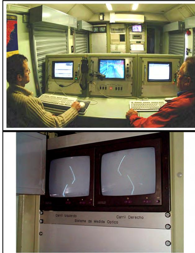
Figura 7.2.- Laboratorio del coche de control geométrico de vía SIV 1002 de RENFE (consola de control y monitores de los carriles). Fuente: RENFE.
