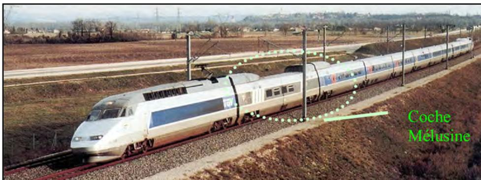
Figura A-VII.28.- Coche Mélusine integrado en una rama de alta velocidad del TGV de la SNCF. Fuente: Mercurio (2002).
