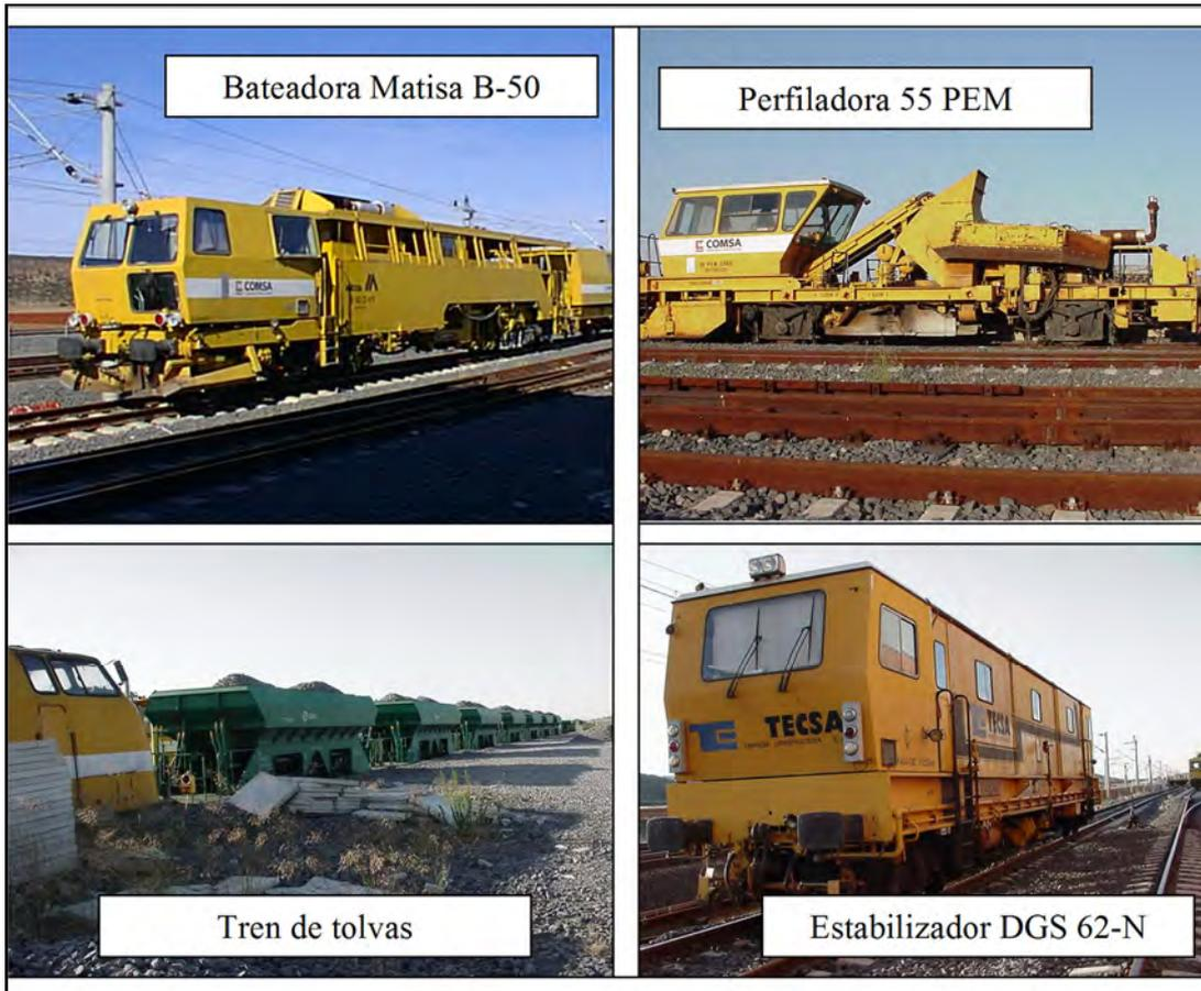
*Figura A-VIII.6.- Maquinaria pesada de la Base de Mantenimiento de Calatrava en la línea del AVE Madrid – Sevilla. Fuente: fotografías realizadas por el autor.*
