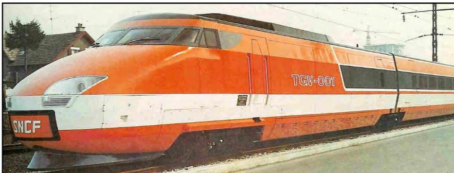
Figura 2.3.- Turbo-tren experimental TGV 001 de 3760 kW (dotado de turbina de gas), que en 1972 alcanzó los 318 km/h. Fuente: Lorin (1981).
