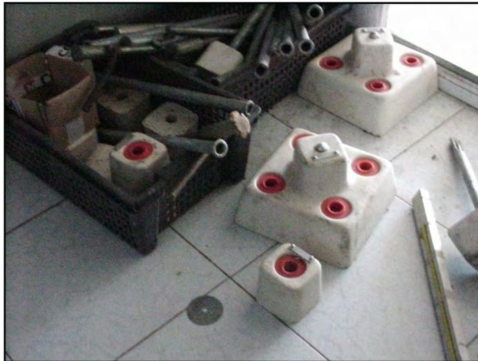
Figura A-VII.1.- Mojones de 4 anclajes y 1 anclaje para materializar una base de replanteo. Fuente: fotografía realizada por el autor.
