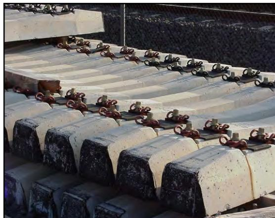
*Figura 4.13.- Acopio de traviesas monobloque DW en la base de mantenimiento de Calatrava en la línea del AVE Madrid – Sevilla. Fuente: fotografía realizada por el autor.*
