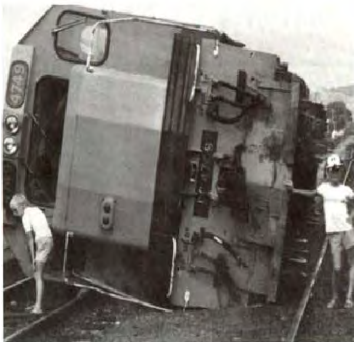
Figura 1-44. Terremoto de Edgecumbe, Nueva Zelanda (02-03-1987), magnitud 7.5. Las imágenes superiores y la inferior derecha muestran daños del Tipo II. La inferior izquierda muestra el vuelco de una locomotora diesel correspondiendo a daños del Tipo I.
