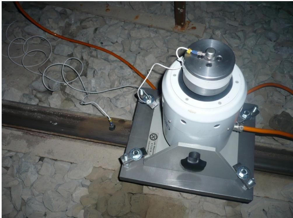
Figura 5.2 Disposición del actuador electrodinámico fijado a la cabeza del carril encima de una traviesa.
