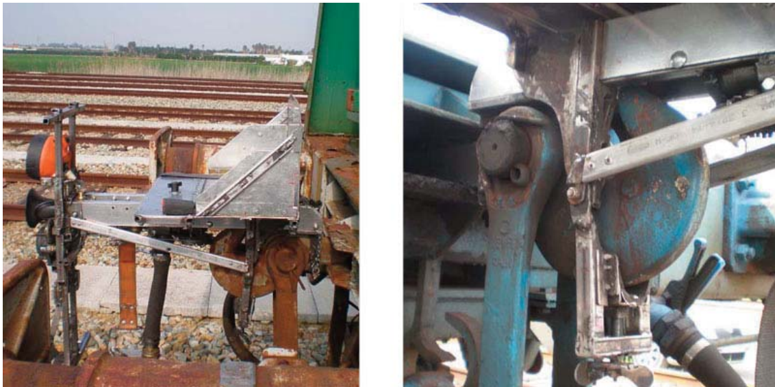
Fig. 2. Anclaje en el gancho de tracción
