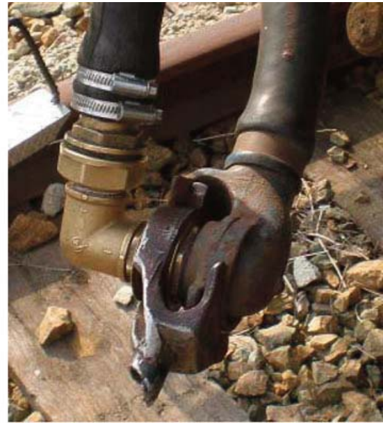
Fig. 3. Acoplamiento de manga de freno
