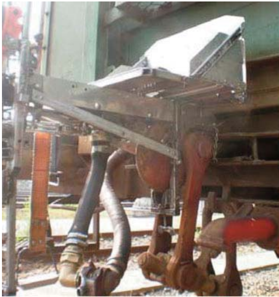
Fig. 3. Acoplamiento de manga de freno
