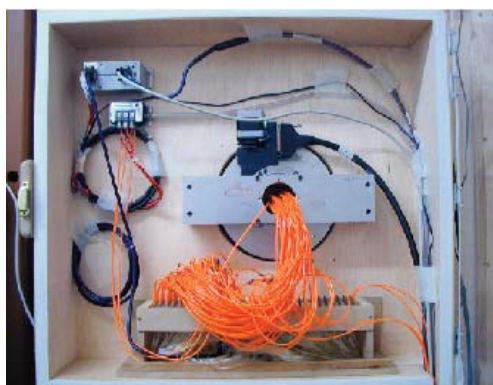
Fig. 7. Instrumentación para la medida de presiones sobre el modelo de coche de tren.
