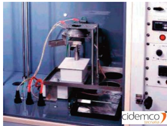
Fig. 3a-b. Cámara de valoración de densidad óptica de humos con FTIR acoplado (ISO 5659).
