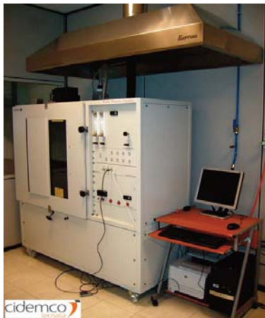
Fig. 3a-b. Cámara de valoración de densidad óptica de humos con FTIR acoplado (ISO 5659).
