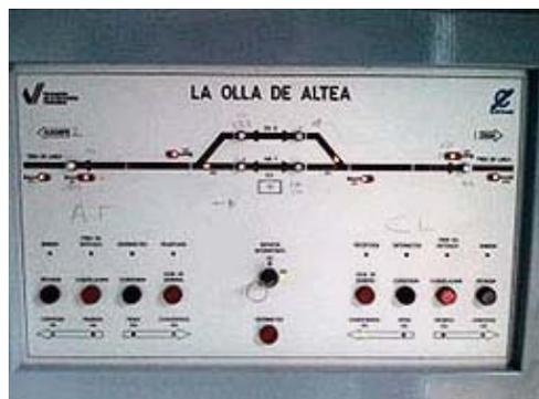
**Fig. 2** Cuadro de operaciones del bloqueo eléctrico manual
