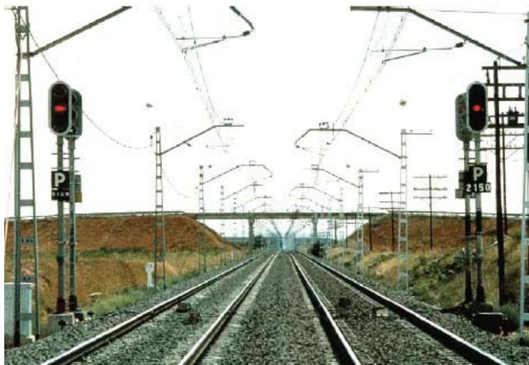
**Fig. 7** Vista de un de trayecto con bloqueo automático banalizado
