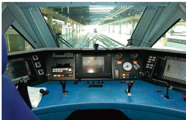
**Fig. 13.** Pupitre de locomotora con ASFA DIGITAL<sup>5</sup>
