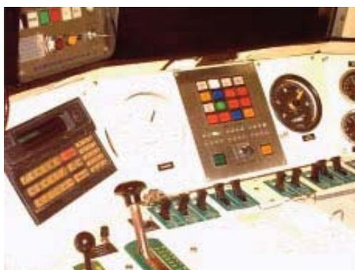
Figura 11. El ASFA en el pupitre de conducción
