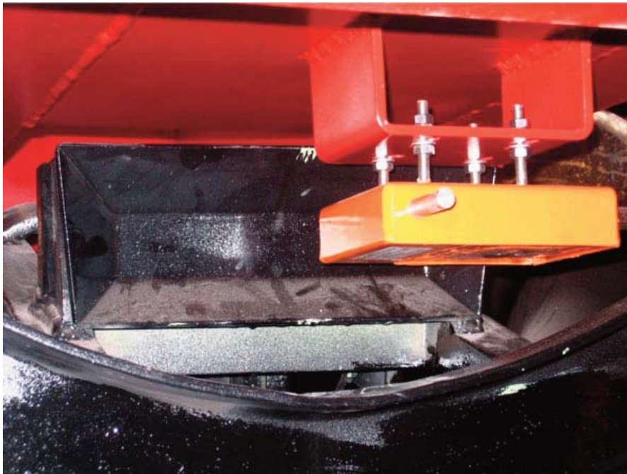
Fig. 2. Vista del pulsador (posición desarmado) y campana 3DyFAT®
