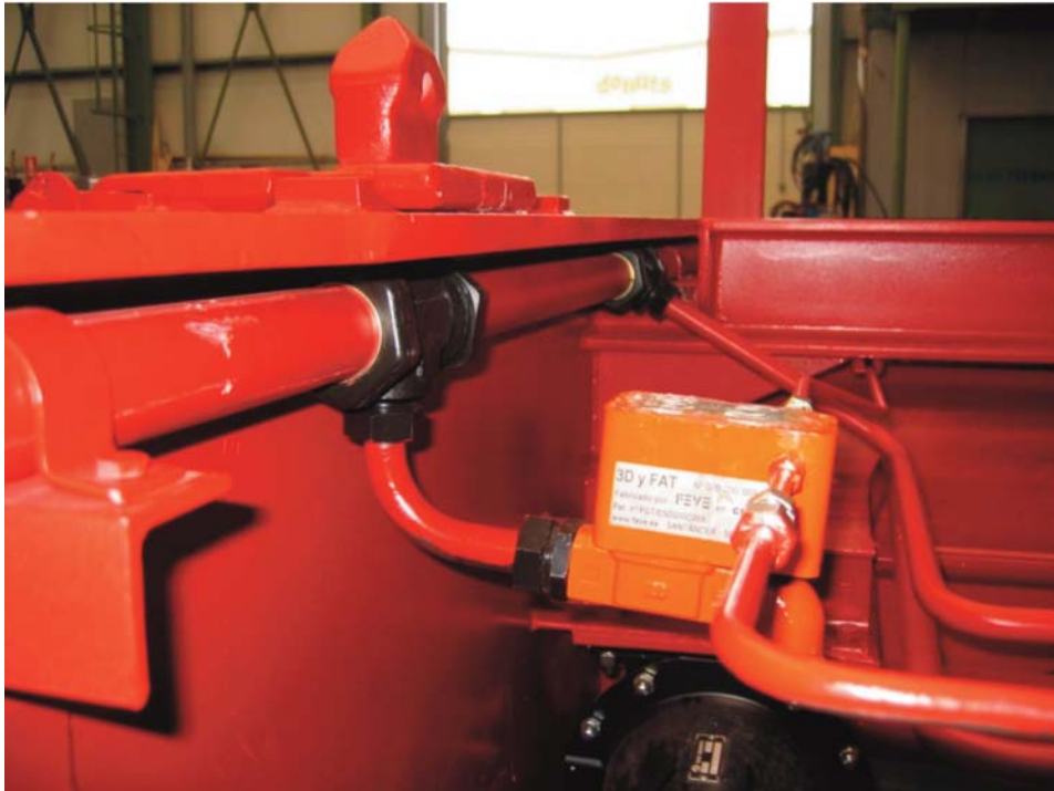
Fig. 4. Válvula automática del 3DyFAT®
