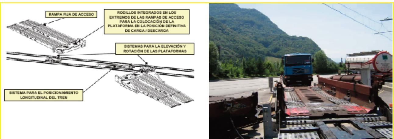
Figura 12. Instalaciones de carga y descarga AF de Aiton (Modalhor)
