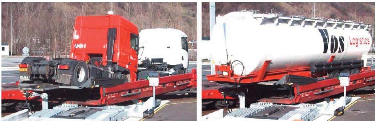
Figura 8. Carga de vagones de Modalohr AFA en Aiton (cerca de Lyon)
