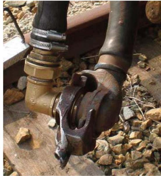
**Fig. 3. Acoplamiento de manga de freno**
