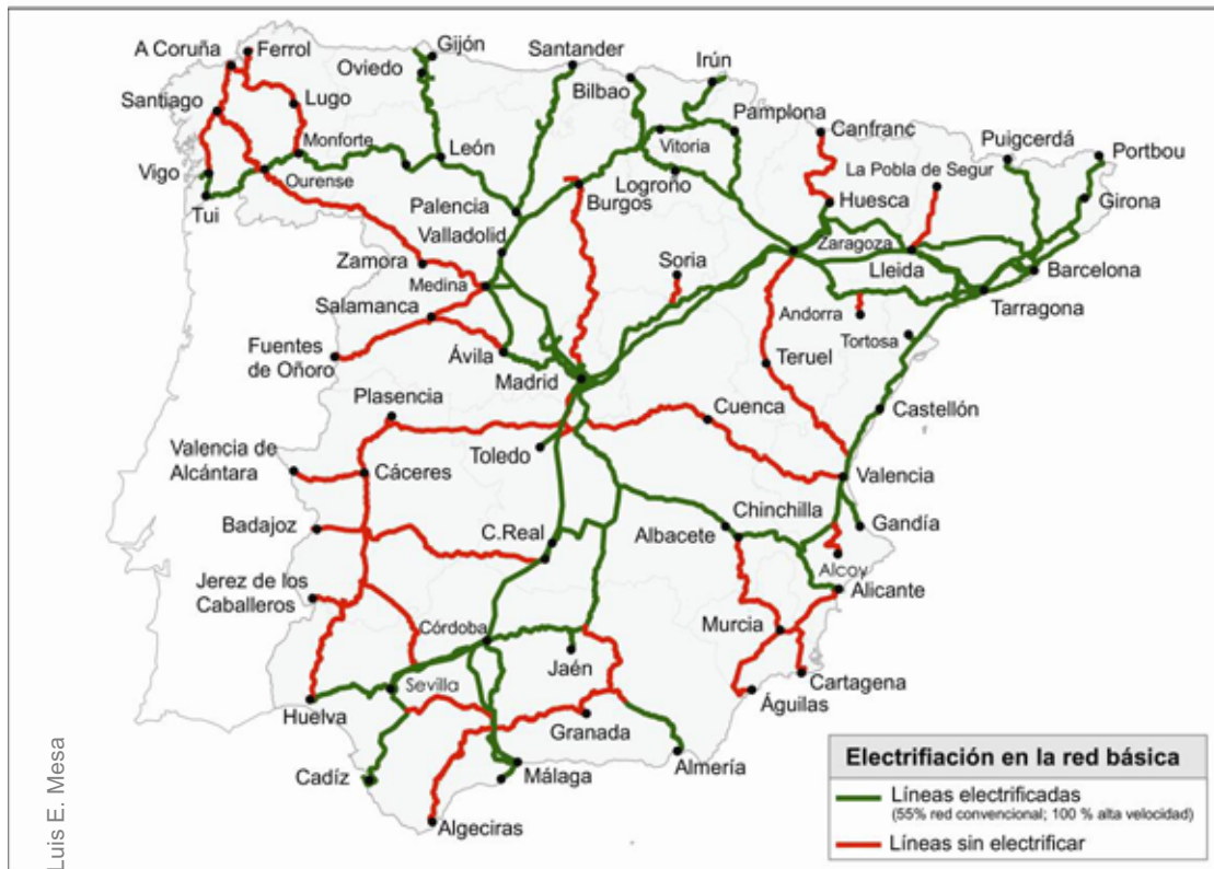
Fig. 1. Electrificación de la red ferroviaria básica en 2010. El porcentaje de líneas electrificadas es del 60,21%
