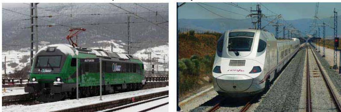
Fig. 2. Locomotora dual Bitrac (CAF) y tren autopropulsado 130 (Talgo) del que se deriva el 730 dual
