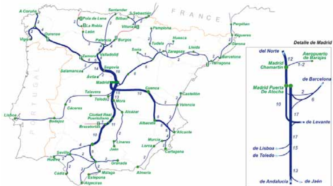
Fig. 1. Estructura de la red española de alta velocidad. Puede apreciarse cómo los tramos troncales próximos a Madrid el tráfico que discurre por una línea con dos vías se ramifica hasta por en ocho líneas con 16 vías en la periferia
