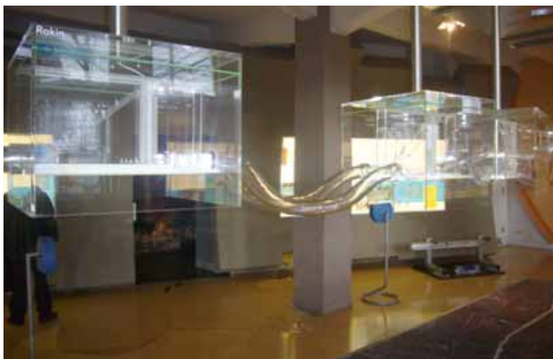
Fig. 5. Maqueta de la nueva Noord/Zuidlijn Lijn del Metro de Ámsterdam, en la que se puede apreciar cómo las estaciones están en una cota más alta que los tramos colaterales.
