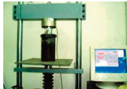
Figuras 4 y 5. Ejemplo de probetas y ensayo a compresión simple.
