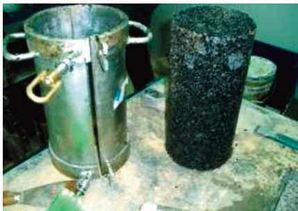
Figuras 4 y 5. Ejemplo de probetas y ensayo a compresión simple.
