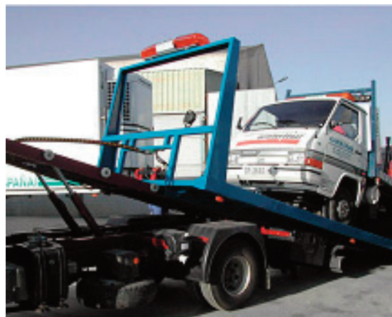
Fig.15 Sistema de guiado en grúas portavehículos
